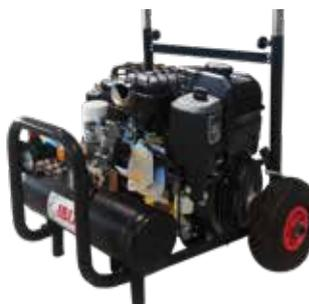
Compresseur d'air avec unité de compression à vis sur roues pour une polyvalence et une compacité maximales
