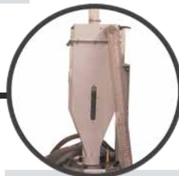
Le cyclone peut décharger le matériau dans le réservoir ou directement dans l'aérogommeuse **IBIX**. Le cyclone peut être équipé de système de levage à rails avec vérin pneumatique, ou fixé en position supérieure (voir le schéma). La cuve à poussière (1) peut donc être placée sous le cyclone ou l'aérogommeuse **IBIX** (6).
