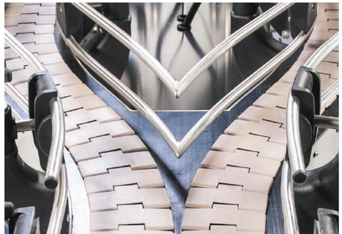
Réalisation de convoyeurs sur mesure en aluminium anodisé ou inox avec courbes de transferts
