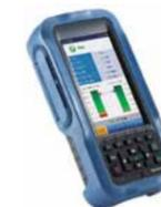
Validation de la boucle locale et de la partie terminal. Testeur ADSL 2+ et VDSL 2 (chipset broadcom).
