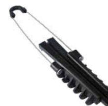
Pince d'ancrage pour branchements aériens, en matière isolante à haute tenue mécanique et climatique pour câble rond fibre optique. Serrage conique automatique ne nécessitant aucun outil de pose. Tailles différentes pour couvrir tous les câbles du marché de 3 à 20 mm.
