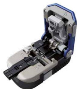
Cliveuse ergonomique, légère et robuste. Retour de chariot automatique, lame auto-rotative et collecteur de fibre intégré. Utilisable à une main avec support de fibre et clapet de mise en attente. Ouverture du capot à 30° et 70°. Durée de vie de la lame : 60 000 coupes.
