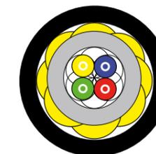
Câble d'abonné extérieur G.657 1, 2 et 4 FO. Tube 900 µm Ø intérieur 4 mm blanc, surgainage déshabillable Ø 6 mm.
