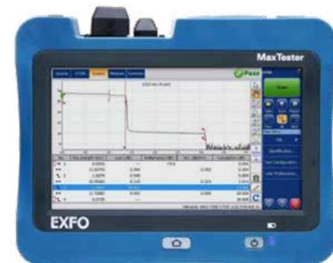
OTDR conçu pour les réseaux courte portée tels que les architectures FTTx et les réseaux d'accès point à point.
