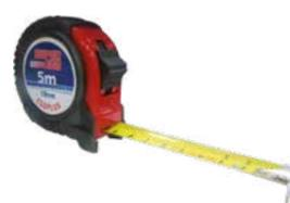
Mètre de 5 m avec protection en caoutchouc renforcée.
