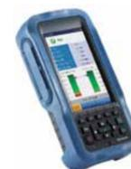
Analyse ADSL2+ et VDSL2 (Chipset Broadcom). Test Triple Play Data VoIP et IPTV.
