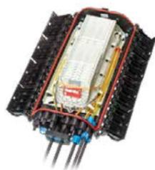
Boîtier d'épissurage IP68 conçu pour les réseaux FTTx et le branchement d'abonnés (fibre G.657A et G.652D). Capacité de 48 épissures avec 4 cassettes de 12 épissures. Jusqu'à 18 entrées en ligne (3 à 15 mm). Disponible version avec connecteurs. Étanchéité par joint grommets pour un montage rapide. Kit de fixation murale, chambre et poteau.
