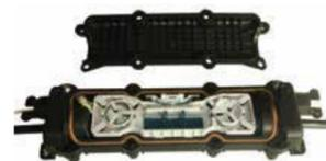
Boîtier d'épissurage IP68 conçu pour les réseaux FTTx et le branchement d'abonnés (fibre G.657A et G.652D). Capacité de 24 épissures avec 2 cassettes de 12 épissures. Jusqu'à 18 entrées en ligne (3 à 15 mm). Disponible version avec connecteurs. Étanchéité par joint grommet pour un montage rapide. Kit de fixation murale, chambre, poteau.
