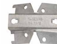
Semelle pour appui bois - acier galvanisé à chaud. Fixation de la traverse par 2 boulons d'assemblage 14 x 25 mm. Fixation par 2 feuillards de 20 x 0,7 mm.
