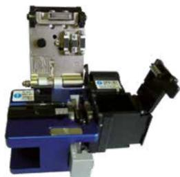
Cliveuse avec retour de chariot manuel, lame auto-rotative ou fixe, dotée d'un collecteur de fibre. Structure robuste en métal. Durée de vie de la lame : 60 000 coupes sans intervention.
