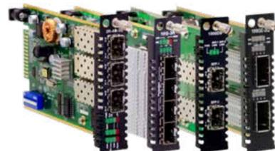
Permet de modifier la longueur d'onde ou sert de répéteur. Existe pour des débits de 100 Mbps à 100 Gbps pour les protocoles Ethernet, OTN, SDH, FC, ect.
