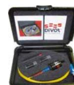
Mesure sur touret, fibre monomode et multimode. Fonctionne sur fibre clivée et non clivée, connexion par gel d'indice.
