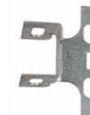
Pour poteau béton - acier galvanisé à chaud. 2 semelles nécessaires pour la fixation d'une traverse 13 ou 15 trous - par 2 boulons d'assemblage 14 x 25 mm. Fixation par 2 feuillards de 20 x 0,7 mm.
