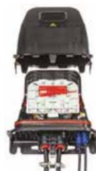
Boîtier d'épissurage IP68 conçu pour les réseaux FTTx et le branchement d'abonnés (fibre G.657A). Capacité de 72 épissures avec 4 cassettes de 18 épissures. Jusqu'à 12 ports individuels (4 à 7 mm) et ports doubles (6 à 16 mm). Étanchéité par joint grommet pour un montage rapide. Kit de fixation mural, chambre, poteau. Volume < 2L.
