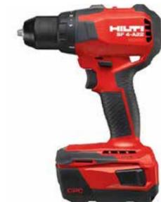
Visseuse compacte sans fil 22 V. Moteur sans balai pour des performances optimales lors de tâches légères et dans des endroits difficiles d'accès. Couple maximal (vissage en douceur / force), 36 Nm bois tendre et 62 Nm bois dense. Vitesse de rotation à vide 1 = 610 tr/min, 2 = 2 100 tr/min. Plage de serrage du mandrin 2 à 13 mm.
