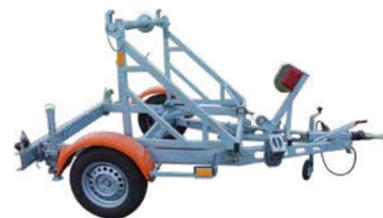
Destinée au transport et déroulage de touret de câble (Ø de 1 000 à 1 600 mm). Chargement et déchargement rapide du touret < 15 min. Charge utile 500 à 750 kg.
