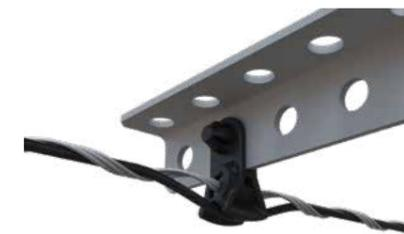
Fixation intuitive, sans erreur possible et très rapide (1 seul installateur). Montage et démontage sans outil. Résistant aux UV. Montage directement sur armements Orange. Durée de vie de plus de 30 ans. Montage jusqu'à 20 degrés d'angle. Excellente tenue au glissement grâce à la technologie préformée. Disponible pour câble de 4 à 15 mm.
