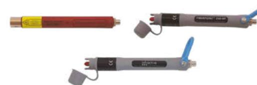
Test de continuité et détection visuelle de contrainte, mode pulsé et continu. Portées de 3-4, 4-5, 9-10 et 15 km.
