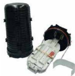
Boîtier d'épissurage IP68 conçu pour le transport et la distribution des réseaux FTTx (G.652D et G.657A). Capacité de 48 à 1 536 fibres. Jusqu'à 7 ports, technologie SFMS constituée d'embase séparable pour le changement facile de la configuration de câble. Étanchéité par joint grommets pour un montage rapide. Kit de fixation murale, chambre, poteau, câble ADSS.
