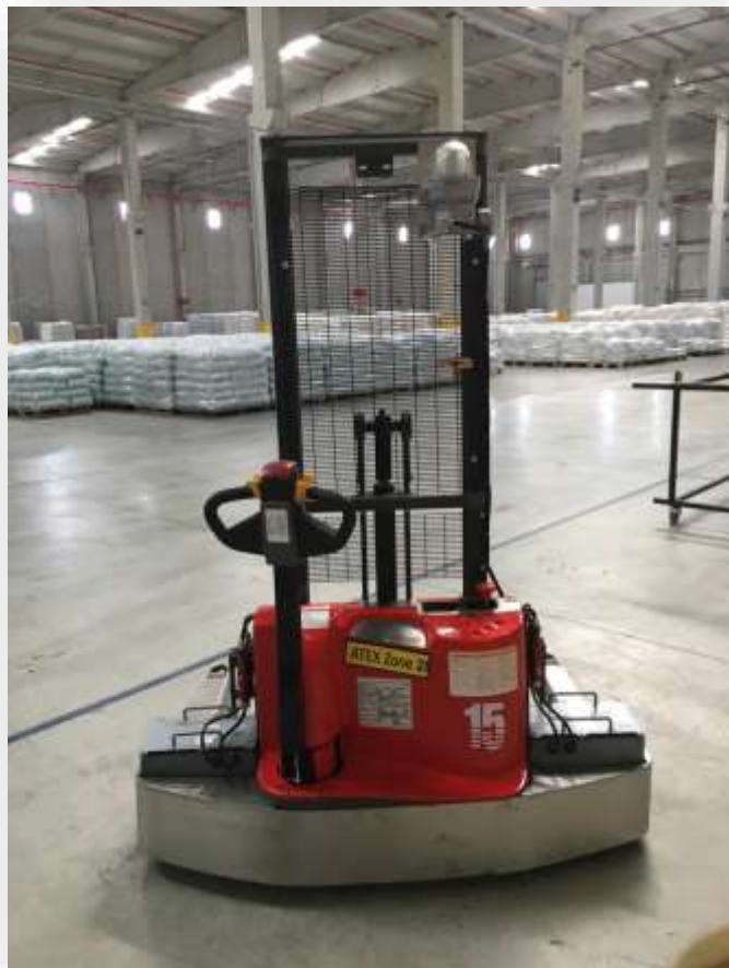
GERBEUR ELECTRIQUE MAT MONOPOUTRE 1500 KG
