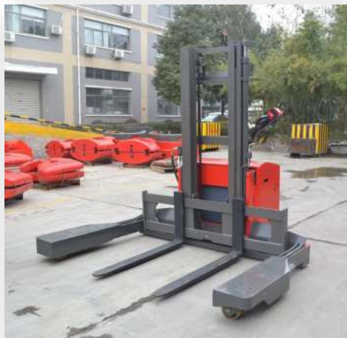
GERBEUR ELECTRIQUE 1.5 T MULTIDIRECTIONNEL
