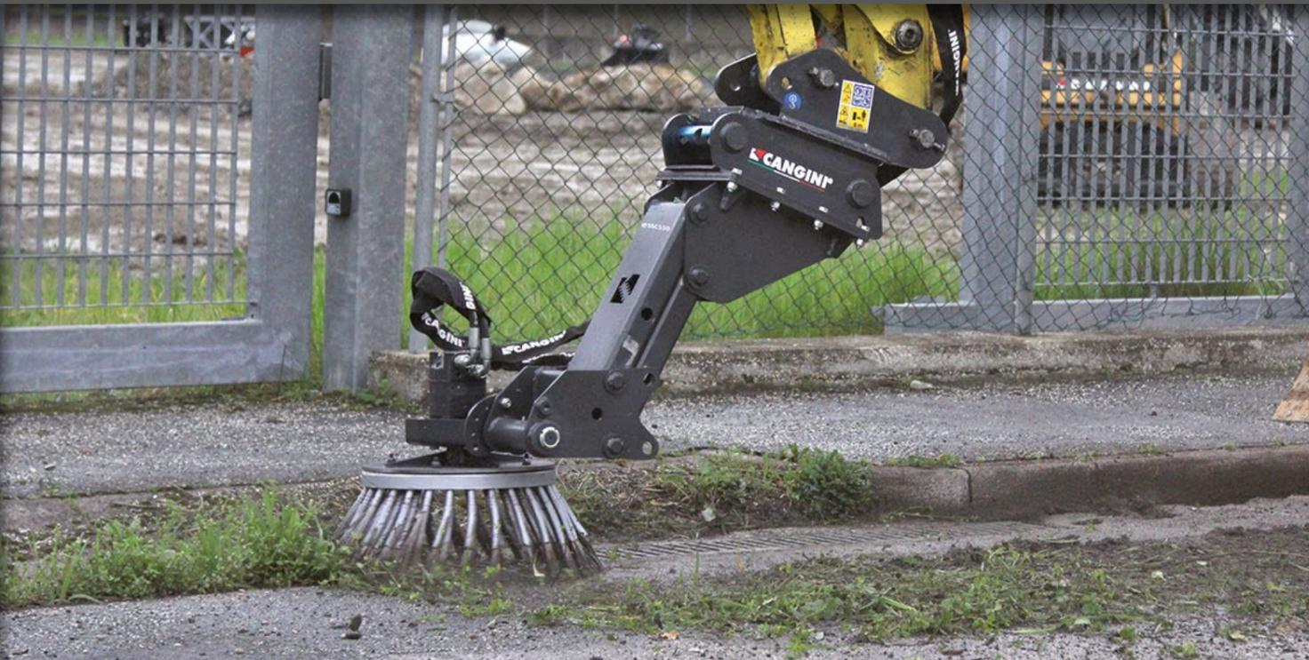
CETTE BROSSE, POUR PELLETEUSE, DOTÉE D'ÉLÉMENTS EN ACIER, EST ADAPTÉE AU NETTOYAGE DE BORDURES, TROTTOIRS ET ACCOTEMENTS DES ROUES. LE SYSTÈME FLOTTANT ET LE JOINT, DE SÉRIE, PERMETTENT À LA BROSSE DE SUIVRE LES SURFACES. LES DEUX SYSTÈMES D'ARTICULATION PEUVENT ÊTRE BLOQUÉS EN POSITION FIXE SELON LES EXIGENCES DE L'UTILISATEUR. EN ADOPTANT LA BROSSE EN PPL ON PEUT TRAITER LES SURFACES LES PLUS DÉLICATES OÙ LE DÉSHÉRBAGE N'EST PAS NÉCESSAIRE.
