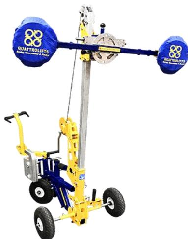
Le chariot EXPRESS 200 CW permet la manutention et le pose de panneaux verre, plastique ou bois non poreux et particulièrement les ouvrants du bâtiment tels les vitrages, les châssis vitrés ou les portes. L'équilibre du chariot est assurée par un essieu arrière surmonté de contrepoids. Entièrement démontable et léger, l'EXPRESS 200 CW est un matériel d'appoint adapté pour le chantier ou l'atelier.
