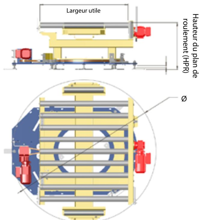
Table tournante avec convoyeur à rouleaux
