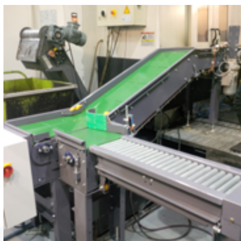
Convoyeur de pièces de fonderie sur centre d'usinage
