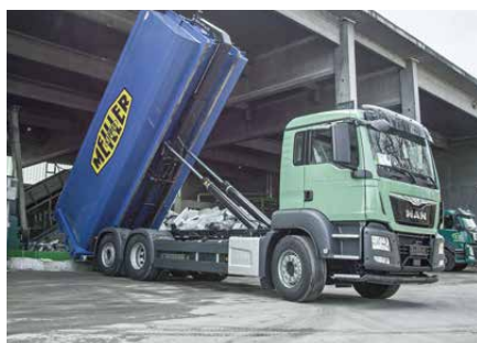
Plus de marge de manœuvre dans les espaces couverts grâce à la carrosserie plus basse de l'ampliroll.
