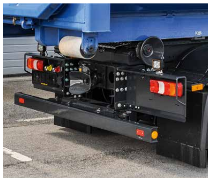
La barre anti-encastrement est toujours en position correcte : rentrée lors du basculement et du roulement, sortie en mode conduite.
