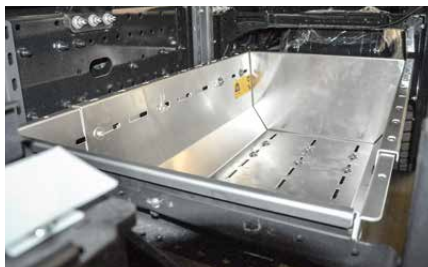
Utilisation de l'espace optimisée : caisse à filets entre les essieux.
