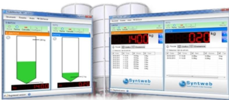
ScaleMonitor.Net est le logiciel pour le contrôle et l'enregistrement, en temps réel, de tous les données des pesées exécutées sur un système de pesage qui se compose d'une ou de plusieurs balances connectées. Il stocke les données dans un fichier d'Excel ou de texte pour un traitement ultérieur.
