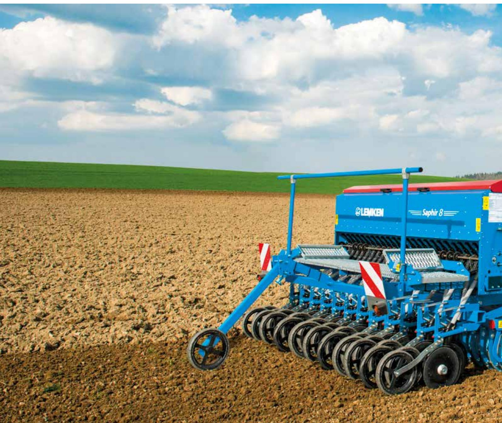
les doubles disques préviennent de tout risque de bourrage. Les roues plombeuses à bandage caoutchouc contrôlent parfaitement la profondeur et permettent des vitesses d'avancement élevées tout en garantissant une dépose précise, régulière et une levée homogène de la semence et ce dans tous les types de sols.
