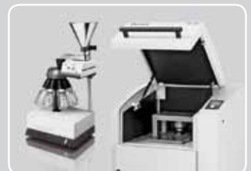
Pour pouvoir ensuite réaliser le broyage ultrafin, il faut commencer par prélever **une fraction d'échantillon représentative**, par ex. à l'aide du diviseur d'échantillons rotatif PT 100 de RETSCH. Pour la préparation d'échantillons solides destinés à l'analyse par fluorescence X, RETSCH propose différentes presses à pastiller.
