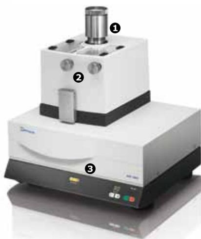
La durée de broyage se règle numériquement entre 0 et 99 minutes, le fonctionnement continu est aussi possible. Outre la durée de broyage, la pression d'appui du pilon et sa position dans le mortier influent beaucoup sur le résultat du broyage. La pression d'appui se règle aisément par le biais d'une échelle (1) sur le couvercle de la chambre de broyage. Deux boutons tournants (2) permettent d'ajuster la position du pilon et celle du racloir. Le RM 200 dispose d'un affichage de
