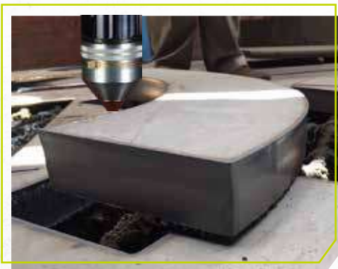
Découpe de 70 mm avec H35/N 2 à 600 A
