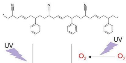
La formation de radicaux libres provoque des ruptures de chaîne sur les doubles liaisons, nitriles et chaîne carbonée.
