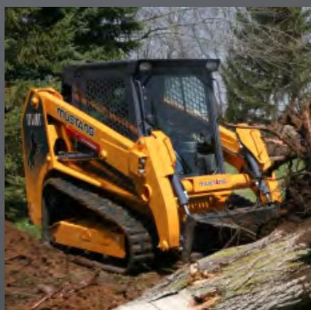
**LA TECHNOLOGIE ANTI-BLOPAGE ▲** détecte électroniquement la charge de la machine, en surveillant et en ajustant la pompe à commande hydrostatique. L'effort de traction est ainsi de 5 371 kg sur le 1750RT, et de 5 606 kg sur le 2100RT.
