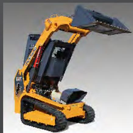
**L'ENTRETIEN ▲** est facilité grâce au grand capot-moteur muni d'un vérin à gaz, et à l'ensemble ROPS/FOPS inclinable. Un compartiment breveté escamotable permet de nettoyer parfaitement l'espace prévu pour les jambes, et d'accéder aux composants situés sous la cabine.
