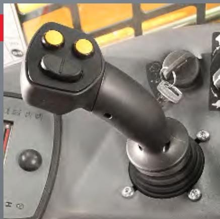
**LE SYSTÈME DE COMMANDE DE TRANSMISSION 5x5 ▲** offre cinq réglages qui permettent de modifier cinq paramètres en fonction des préférences de l'opérateur et des exigences de l'application.
