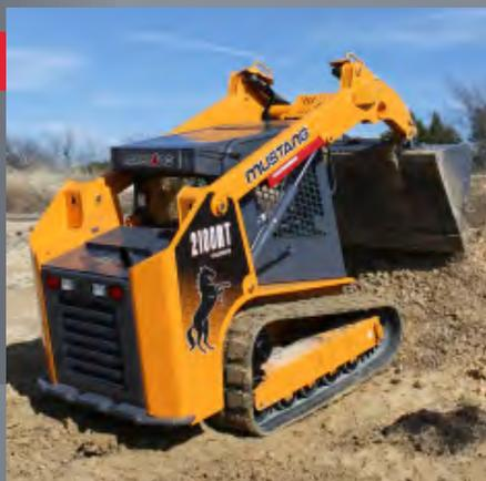
**LE BRAS DE LEVAGE RADIAL OPTIMISÉ ▲** offre une plus grande résistance et une hauteur de levage supérieure à 3 251 mm, inégalée chez la concurrence dans la même catégorie de poids.
