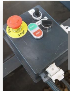
Boîtier avec prise pour contrôle externe (option)
