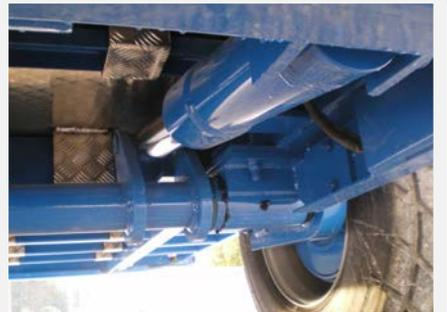
Essieu démontable (boulonné)
