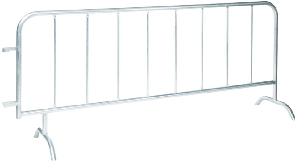
Les barrières de police 8 barreaux sont en **acier galvanisé à chaud après soudures, suivant la norme EN ISO 1461** pour une meilleure **résistance aux chocs et aux intempéries**. Elles sont composées d'un barreaudage de diamètre 16 mm et de tubes acier diamètre 38 x 1.5 mm.
