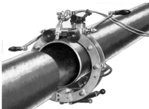
Modèle 0 pour tube Ø ext. 70 à 120 mm.
