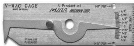
V-WAC #5 Contrôle facile et rapide des 4 mesures essentielles ; profondeur, comparaison de porosité, quantité de porosité, hauteur du cordon (métrique et pouce).
