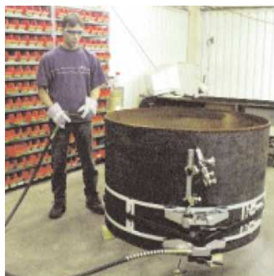
Rails guides et Flexible câble de commande déporté 9'
