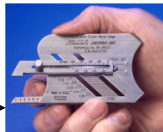
V-WAC #5 Contrôle facile et rapide des 4 mesures essentielles ; profondeur, comparaison de porosité, quantité de porosité, hauteur du cordon (métrique et pouce).
