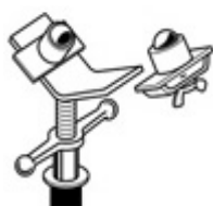
Tête V roulement à bille CMU 450kg
