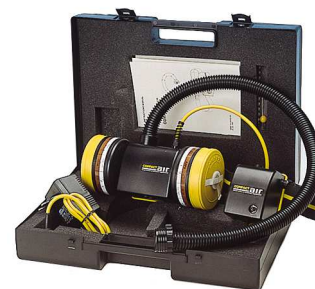
Unité d'air filtré spécial soudage : le système de protection respiratoire Compact-air avec cagoule Gamador relevable. Adaptation de la Prota shell : Cagoule Gamador Ventilateur + ceinture 6 filtres P3 Batterie, chargeur. Tuyau 0.8 m. Indicateur d'air frais Coupe circuit 1.6 A. Coffret.
