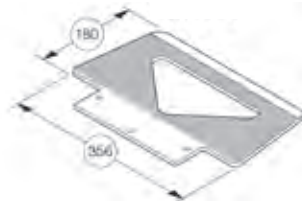
Bavette WL 356 x 180 x 7 mm, entre autre pour les produits blancs et le remplissage de distributeurs automatiques, référence 930 018
