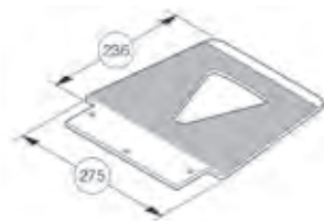
Bavette standard 275 x 236 x 7 mm, rainurée pour empêcher le glissement latéral de la charge, référence 030 025
