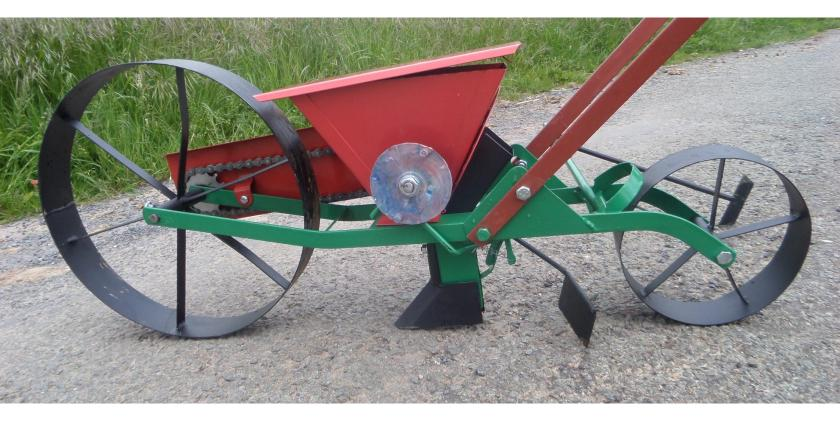
• profondeur de semis maximale: 5 cm
