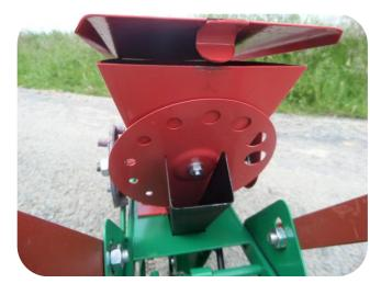
• Diamètre du disques pour des graines de 18 cm à 33 cm
