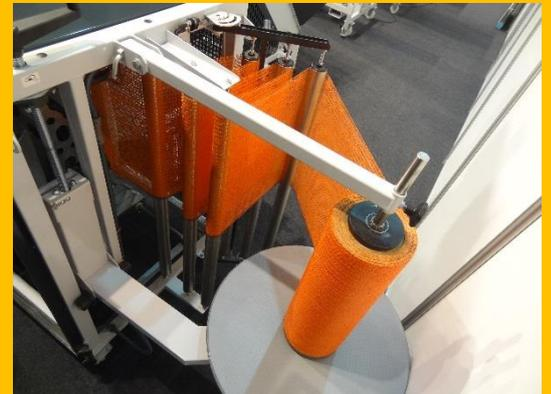
Le principe de fonctionnement du banc couseur consiste à couper les rouleaux de sacs pour en faire des filets individuels, puis à les remplir d'une portion précise de légumes et à les coudre. Le banc couseur R2 est équipé d'une couseuse à deux fils Fischbein 100, tandis que le modèle R1 est équipé d'une couseuse à un fil Fischbein ou Newlong.
