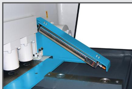
BARRIÈRE IMMATERIELLE devant les serre-tôles. BILLES DE MANUTENTION montées sur la table pour faciliter la manipulation des tôles..
