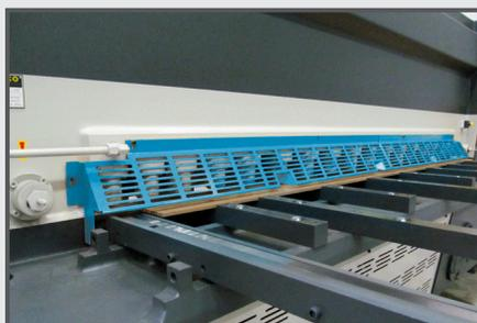
Butée d'équerrage et support avant avec ou sans réglage encastré, rainure en T et cliquet escamotable. Butées d'équerrage de 1000 à 6000 mm, Supports avant de 500 mm à 3000 mm.
