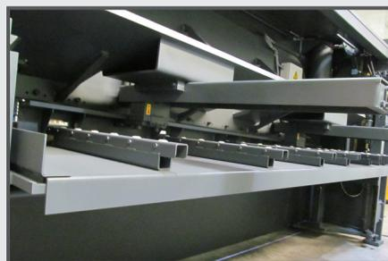
**Possibilité d'extension vers le système SBS** (sheet back to sender) : retour de la bande coupée vers l'avant.
