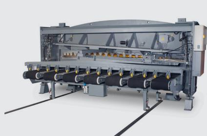
Conveyor et système de support tôles
