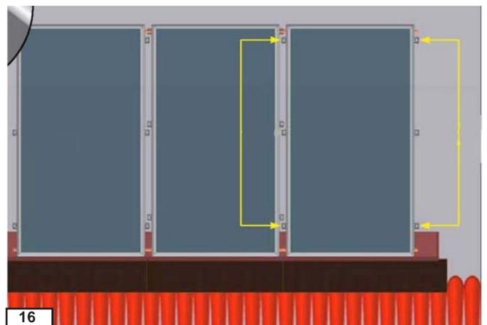
Effectuer les mêmes opérations de montage pour tous les panneaux solaires suivants et les fixer chacun solidement sur la charpente de la toiture au moyen de 4 plaques de blocage.
