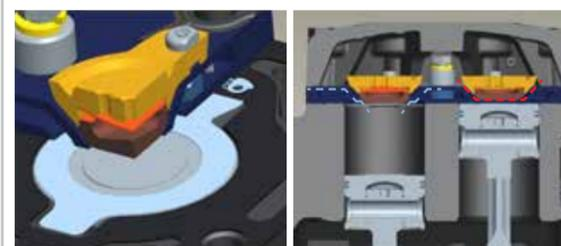
Figure 7: Dans le cas de Stream, le passage de refoulement élargi n'entraîne pas d'augmentation du volume de ré-expansion, ce qui permet d'assurer un rendement optimal quels que soient le réfrigérant et la plage de fonctionnement. La conception n'est donc pas tributaire du réfrigérant qui sera utilisé.
