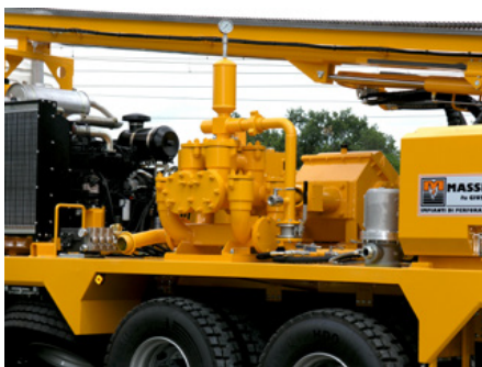
Pompa fango Mud pump Pompe à boue Spülpumpe Bomba de lodo Грязевой насос
