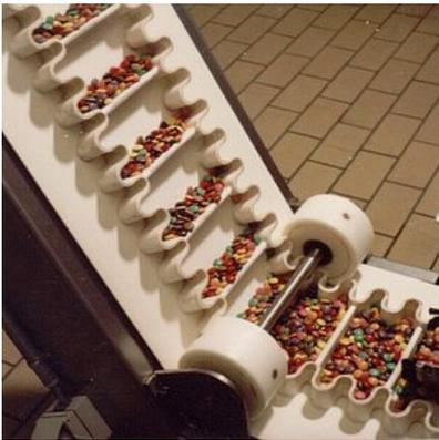
Bande transporteuse PVC avec tasseaux et bordure de contenance ondulée
