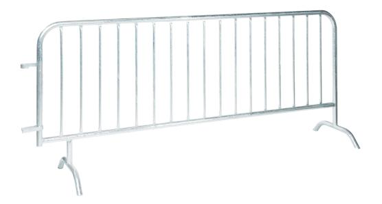
Les barrières de police 17 barreaux sont en acier galvanisé à chaud après soudures, suivant la norme EN ISO 1461 pour une meilleure résistance aux chocs et aux intempéries. Elles sont composées d'un barreaudage de diamètre 16 mm et de tubes acier diamètre 38 x 1.5 mm.
