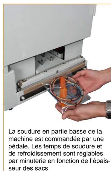
La soudure en partie basse de la machine est commandée par une pédale. Les temps de soudure et de refroidissement sont réglables par minuterie en fonction de l'épaisseur des sacs.
