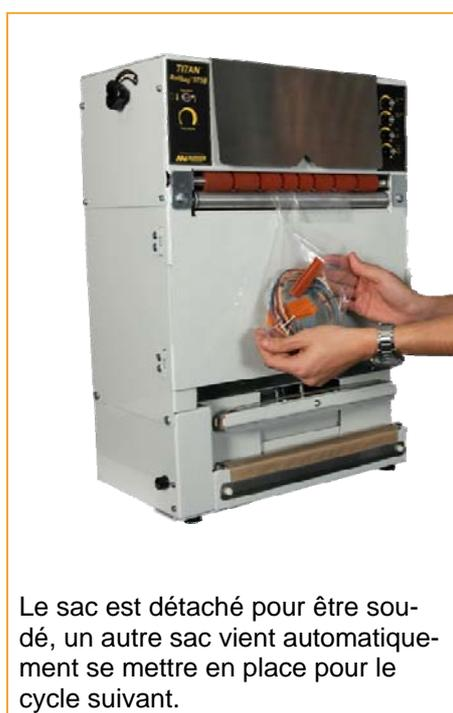
Le sac est détaché pour être soudé, un autre sac vient automatiquement se mettre en place pour le cycle suivant.
