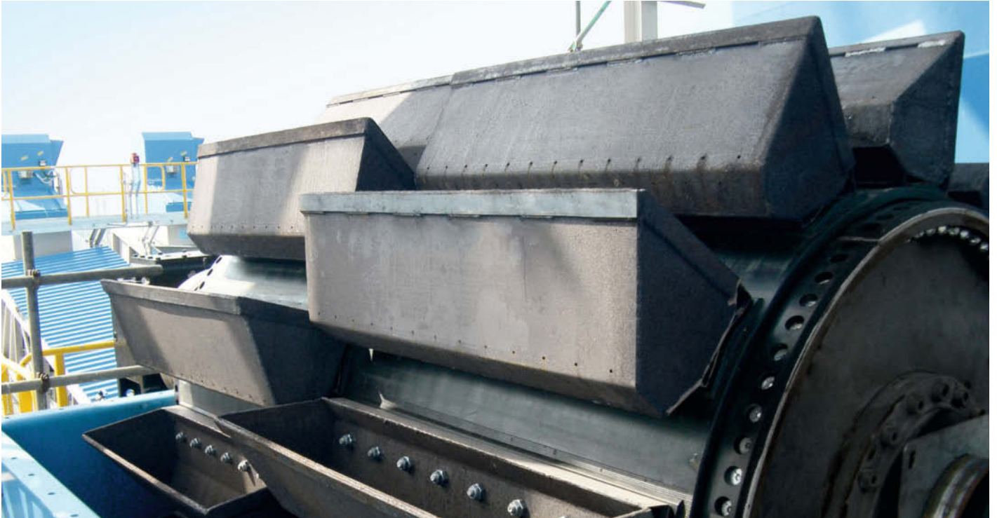
Élévateur à godets à grand débit sur courroie BEUMER, type HD : Tuas Power, Singapour
