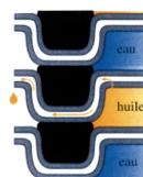
Les flèches indiquent le passage du fluide vers l'extérieur en cas de perforation de la surface d'échange
