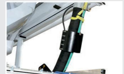
Clapet anti-retour du flexible d'extrémité
