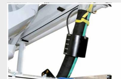
Clapet anti-retour du flexible d'extrémité
