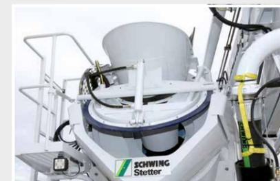
Fermeture de la cuve (verrouillage 3/4 ou plein)
