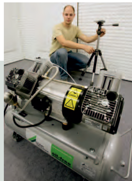
Chambre sourde dernier cri pour la mesure de niveau sonore.
