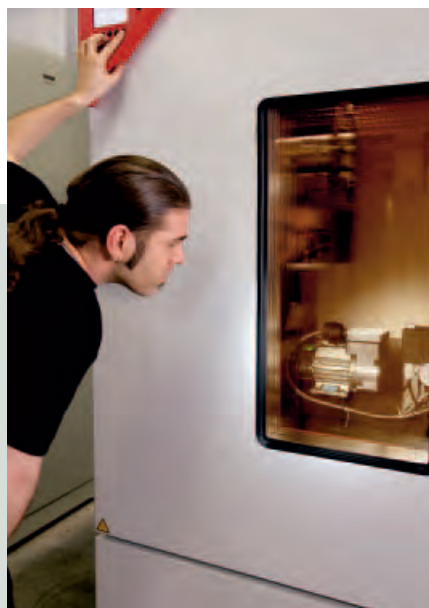
Enceinte climatique – évaluation par tests même dans des conditions extrêmes.
