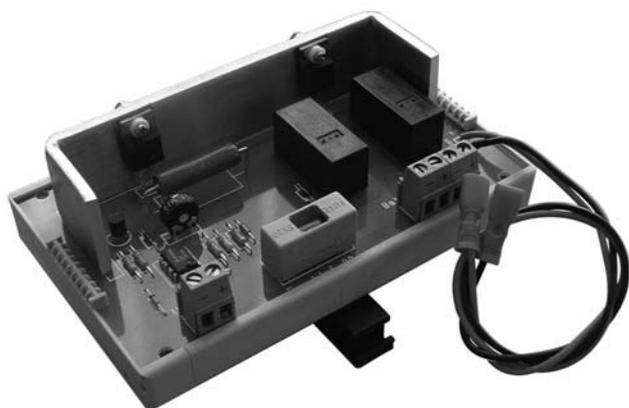
Module permettant de charger des batteries plomb étanche 12VDC / 24 VDC montage sur rail Din
