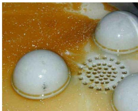
L'huile étrangère est séparée et retenue dans l'appareil où elle est évacuée automatiquement, par surverse
