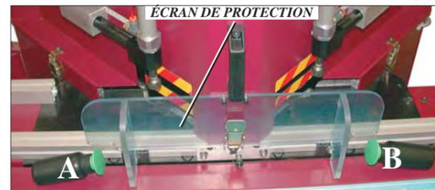
La descente des lames est actionnée par 2 boutons (A-B) mettant les mains de l'opérateur hors de portée des lames. Le relâchement d'au moins un des boutons durant la coupe provoque la remontée instantanée des lames (sécurité opérateur).
