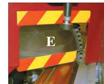
L'écran de protection des lames (E) se règle automatiquement avec le réglage de la hauteur des lames (H) situé en haut de la machine. Le réglage indique en mm le passage maximum pour la moulure à couper.
