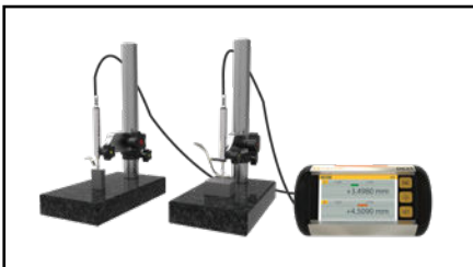
2 mit einer D62S verbundene P12D-Taster.
