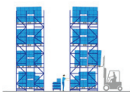
FIFO ou LIFO avec niveau/allée de retrait
