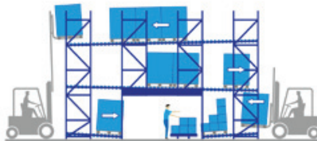
avec tunnel de préparation des commandes
