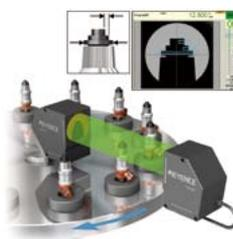
Mesure du diamètre extérieur d'un foret en plusieurs points
