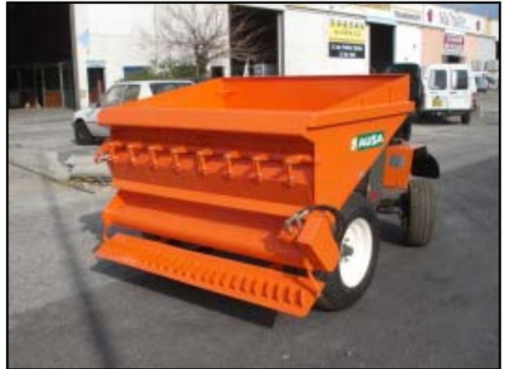
Le gravillonneur 150 est un dumper équipé d'une benne avec système d'épandage de gravillon. La vitesse de rotation du rouleau, entraîné par un moteur hydraulique, est réglable par limiteur de débit et est indépendant de la vitesse d'avancement de la machine. La largeur d'épandage (de 40 à 160 cms. ) et le dosage du gravillon se font par réglage hydraulique de l'ouverture des 4 vannes.
