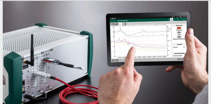
Connexions des capteurs ALMEMO® et pour la mise en réseau (témoin d'état OLED)
