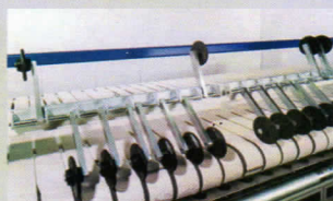
Barre de roulettes d'engagement avec roulettes indépendantes sur toute la largeur de la voie, conseillée pour les tabliers et nappes.
