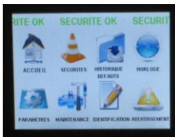
Un **afficheur tactile industriel**, interface conviviale entre l'opérateur et le portail permet d'avoir accès aux informations d'état, de paramétrage et de maintenance de l'installation.
