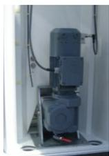
asynchrone triphasé avec réducteur dont la puissance est adaptée à la dimension du
