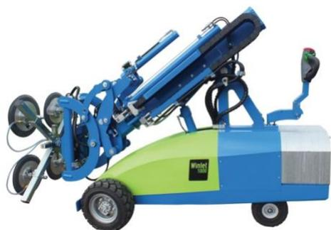
Puissant et précis, le WINLET 1000 dispose de 6 fonctions hydrauliques dont le déplacement latéral et la rotation.
