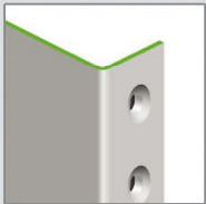
Perçage/ fraisage du blindage
