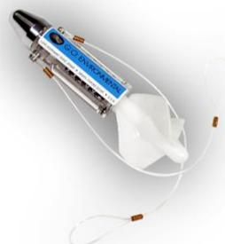
**Courantomètre à hélice**
