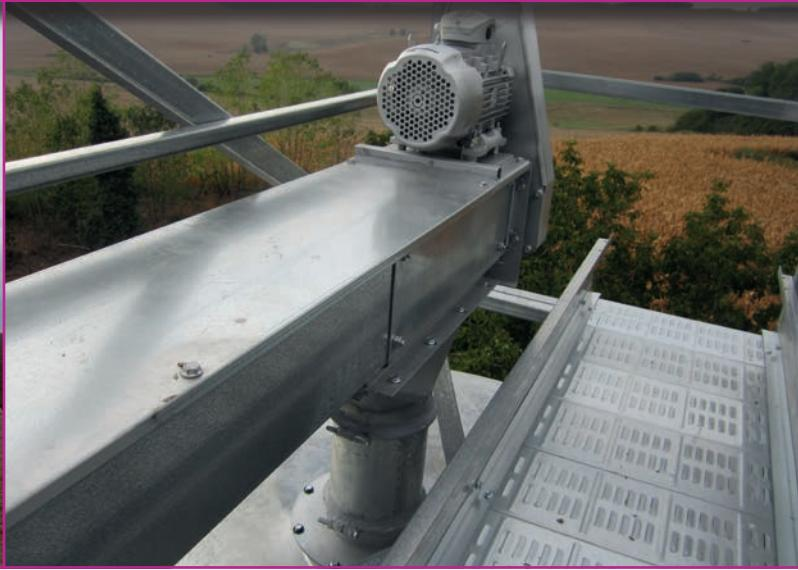
**I trasportatori a coclea** sono utilizzati per il trasporto di cereali, prodotti granulari e sfarinati su percorsi orizzontali o lievemente inclinati (serie CC e CT) o verticali (solo serie CT)
