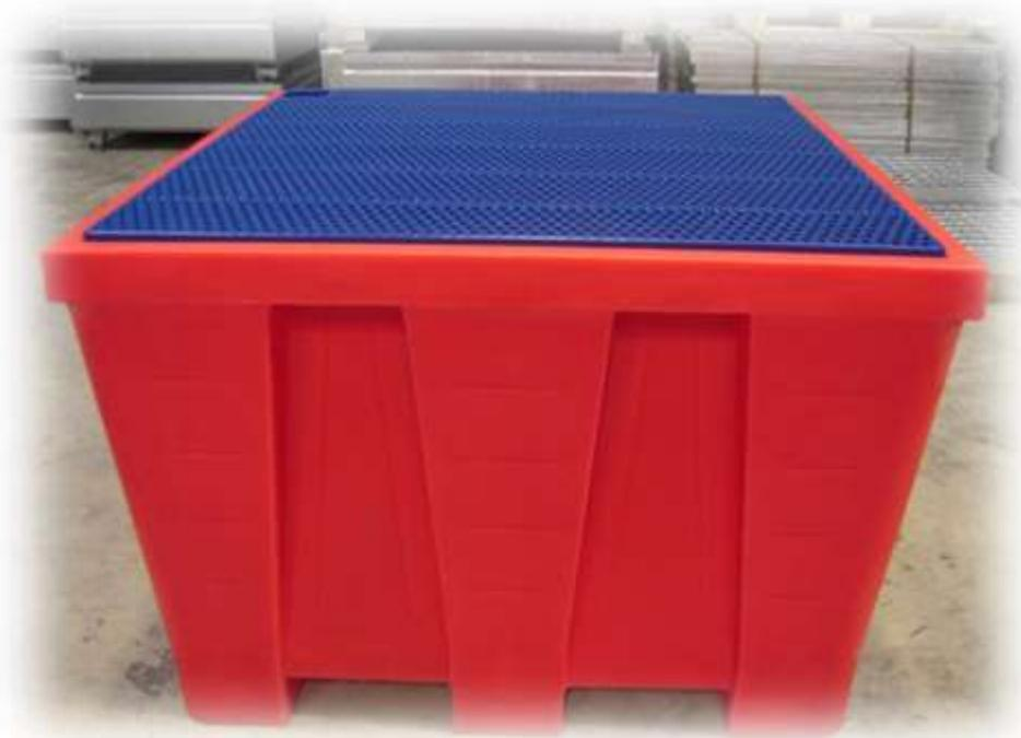
Les bacs de rétention en plastique sont particulièrement adaptés aux acides et bases. 100% polyéthylène, ils regroupent de nombreux avantages : légèreté, facilité de nettoyage, longévité, résistance à la corrosion et aux produits chimiques (hors solvants). Le bac de rétention MRP880 présente une capacité de rétention de 880 litres.
