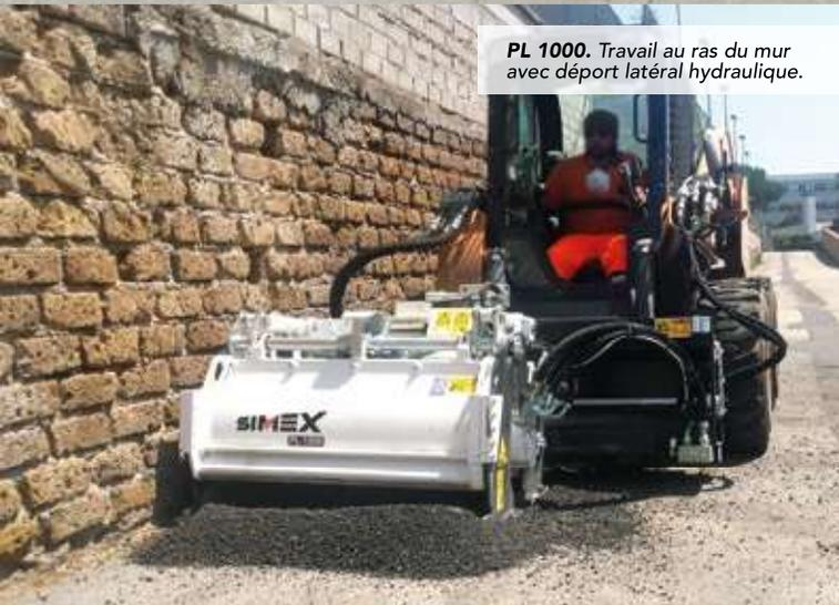
**PL 1000.** Travail au ras du mur avec déport latéral hydraulique.
