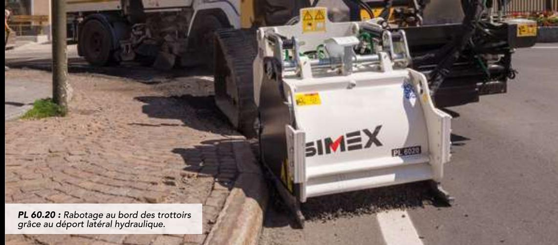
**PL 60.20** : Rabotage au bord des trottoirs grâce au déport latéral hydraulique.
