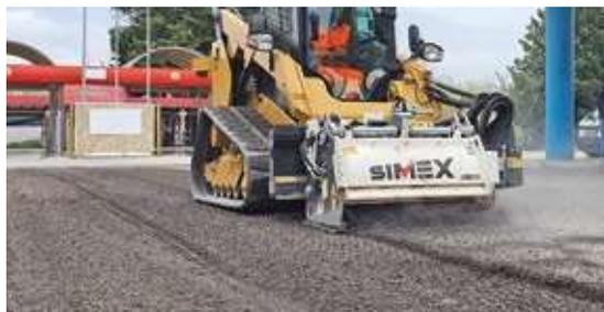
Comme les autres raboteuses de la gamme, les scarificatrices PL bénéficient de solutions brevetées Simex telles que le système d'autonivellement (pour une profondeur de rabotage constante), le réglage indépendant de la profondeur à droite et à gauche, l'inclinaison transversale flottante et le dispositif Performer, qui permet à l'opérateur d'optimiser les performances de l'équipement en fonction de la vitesse d'avancement de la machine.
