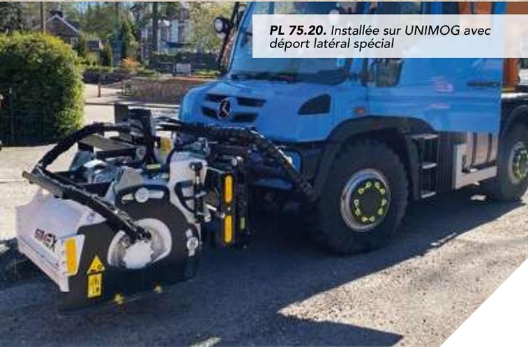
**PL 75.20.** Installée sur UNIMOG avec déport latéral spécial
