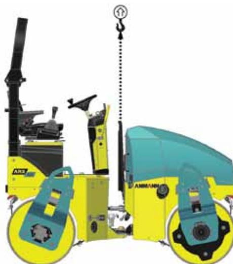
Le point de levage central est un équipement standard sur le modèle ARX1/un équipement en option sur le modèle ARX2
