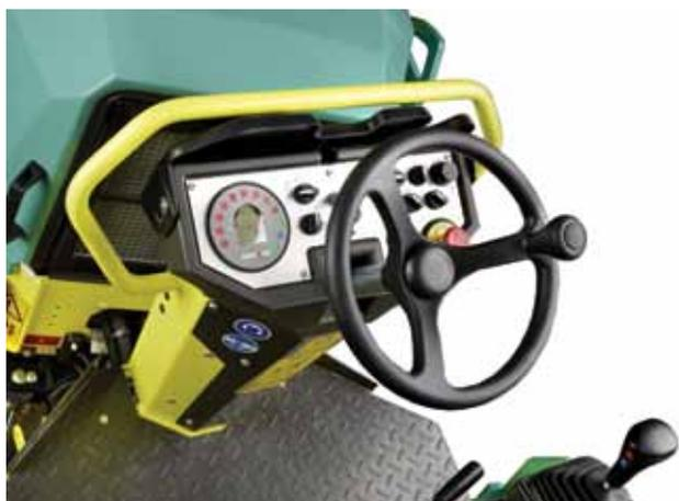
Un tableau de bord isolé des vibrations
